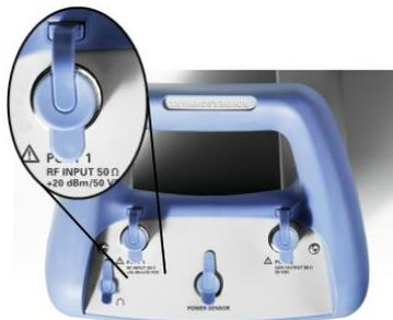
Branchez un câble ou un objet testé à l'entrée RF à l'aide d'un connecteur N. Utilisez un câble pour connecter l'objet testé au R&S FSH, si nécessaire.
