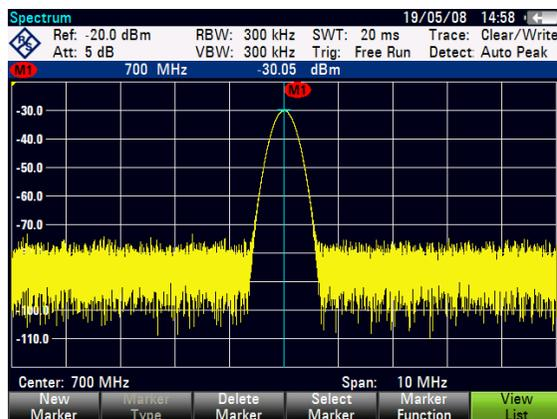
Une ligne verticale bleue représente la position du marqueur sur l'axe horizontal (p. ex. la fréquence).
