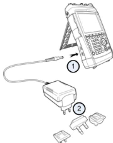
La plage de tension de l'alimentation électrique AC est comprise entre 100 V et 240 V AC.
