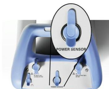
Le connecteur est configuré spécialement pour les sondes de puissance. Il est utilisé à la fois pour l'alimentation électrique et le transfert de données via l'interface de la sonde de puissance.
