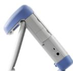
Même en le posant à plat, le R&S FSH est toujours légèrement incliné en raison de la poignée se trouvant en partie supérieure. Cette position offre un angle de vision optimal pour l'écran.
