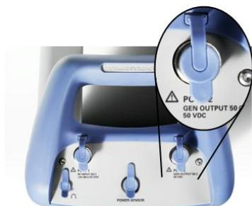
La puissance de sortie du générateur suiveur du R&S FSH est de 0 dBm (valeur nominale).
