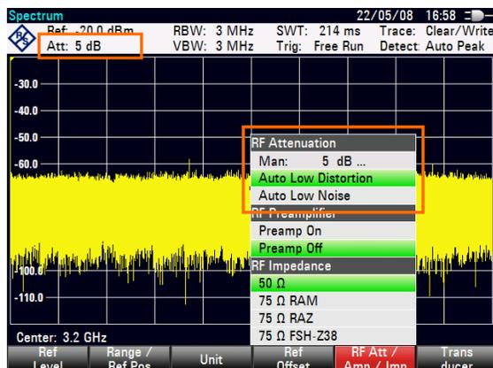
Vous pouvez également régler l'atténuation manuellement. Le R&S FSH permet une atténuation dans la plage de 0 à 40 dB par pas de 5 dB.
